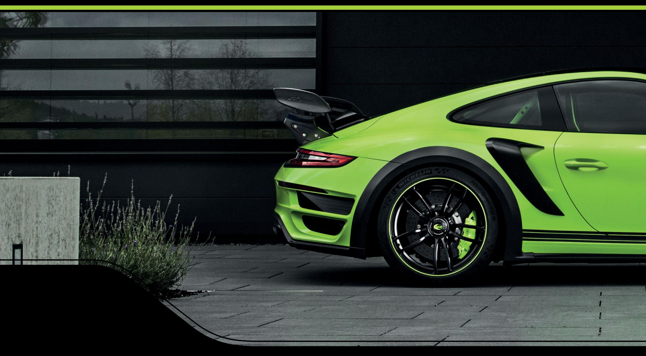
Leichtbau-Kotflügel aus Carbon beherbergen Radhausentlüftungen mit integrierten Carbon-Lamellen. Sie führen die durch Bremskräfte entstehende Wärme ab und reduzieren den Auftrieb im Radhaus. Die Carbon-Seitenschweller setzen die Linie des GTstreet R seitlich fort, und verbinden die Radlaufverbreiterungen an Vorder- und Hinterachse harmonisch miteinander. Für maximale Ladeluftkühlung sind an den Fondseitenteilen des TECHART GTstreet R Lufteinlässe aus Kohlefaser montiert.
